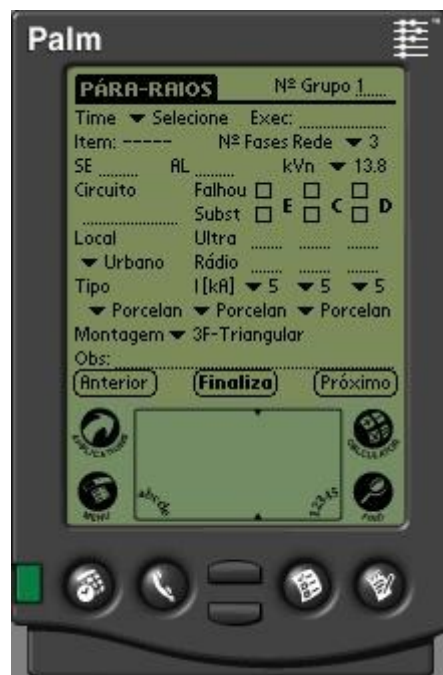
Figura 4 - Programa de inspeção de pára-raios.
