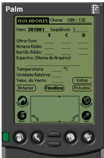
Figura 3 - Segunda tela de inspeção de isoladores.
