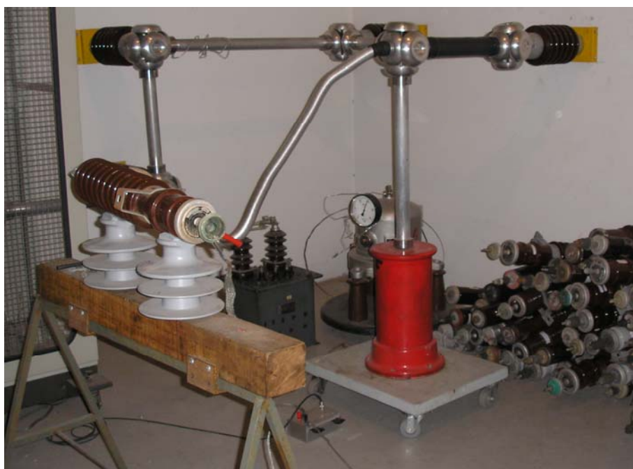
Figura 3 – Configuração do ensaio de RIV
