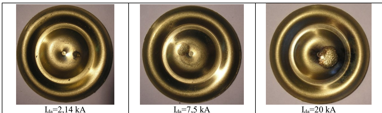
Figura 5 – Resultados de Descargas Atmosféricas em Eletrodos de Pára-Raios Convencionais
